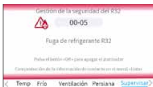
Unidades interiores con detector de fuga integrado
