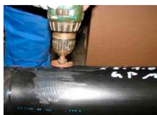
13. Repasar los orificios con una broca.
